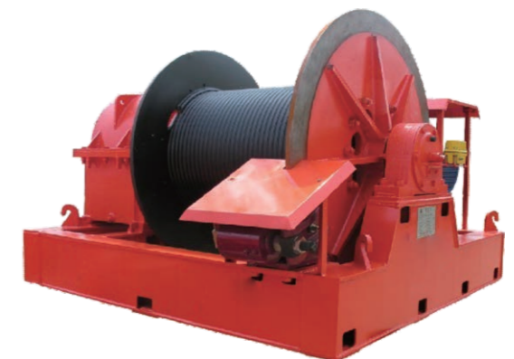
中铁十四局900吨架桥机主起升用 JM12吨卷扬机 容绳量：410m 额定速度：14m/min
