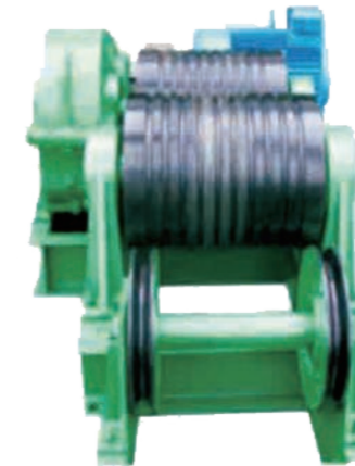
为衡阳钢铁公司废钢回炉生产线 (轨道距离300m,重量260吨) 配套JK5摩擦 式卷扬机, P=50\text{KN} , V=40\text{m/min} 其结构 特点：单机实现自动循环，即生产线运行由 一台设备完成。
